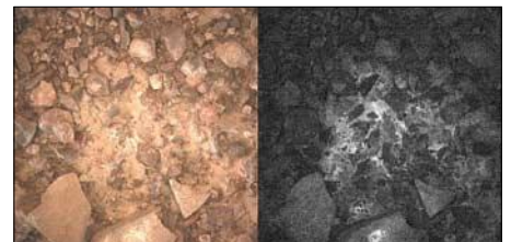
Bild 3: Bei der Beleuchtung von Gesteinsproben mit weißem Licht (links) ist nichts Besonderes zu erkennen. Hingegen sind mit dem Fluorescence Imager durch organische Substanzen hervorgerufene Reaktionen (rechts) bei 620 nm auszumachen.
