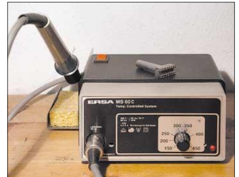
Bild 2: Mit einer elektronisch geregelten Lötstation hat man keine Umstellungsprobleme von bleihaltigem auf bleifreies Lötzinn.
