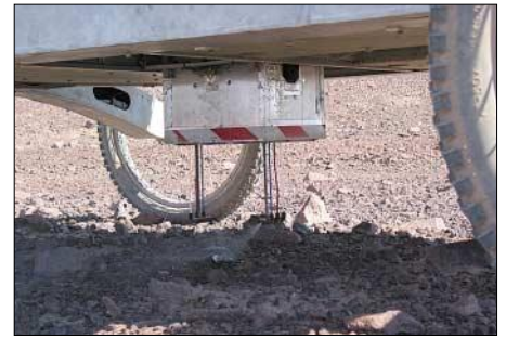
Bild 5: An der Unterseite von Zoë befinden sich Sprühdüsen, Beleuchtung und optischer Sensor des Fluorescence Imagers .
