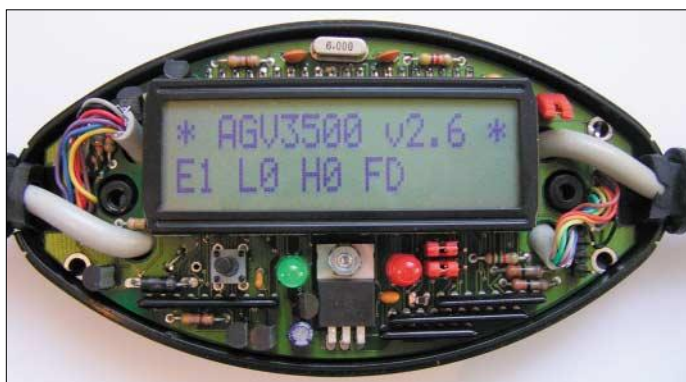
Bild 1: Die Pegel der OBD-Schnittstelle des Kfz passt ein Adapter an die Erfordernisse des Abfragerechners an.
