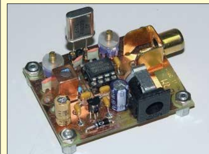
Der DRM-Empfänger AS705, beschrieben im Praxisheft 15, ist als Bausatz beliebt. Foto: AATiS
