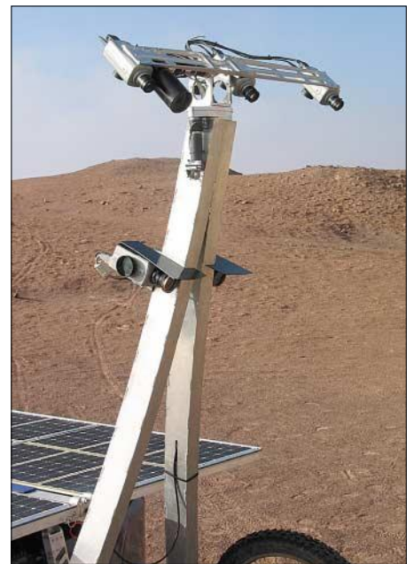
Bild 2: Auf einer dreh- und schwenkbaren Plattform sind die Kameras zur Orientierung des Roboters und für Geländeaufnahmen montiert. Fotos: Carnegie Mellon University
