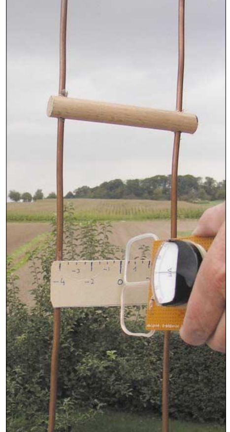
Bild 3: Messsegment mit Paperskala, welches zur präziseren Messung bei Verwendung schmaler Parallelleitung als Zwischenstück eingesetzt werden kann.
