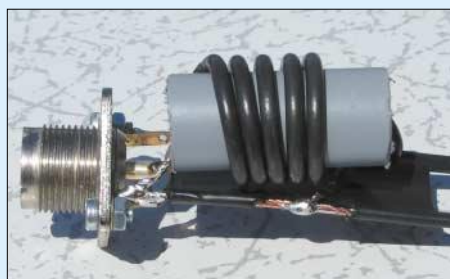
Bild 9: Speisedrossel für die 2-m-J-Antenne aus aufgewickelter RG174-Leitung
