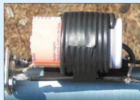
Bild 10: Ausführung der Speisedrossel bei einer 6-m-J-Antenne
