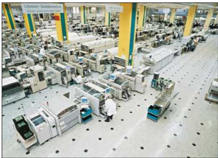
Bild 1: Die Industrie hat zum Teil, wie hier Fujitsu-Siemens in Augsburg, schon auf die bleifreie Fertigung umgerüstet.
