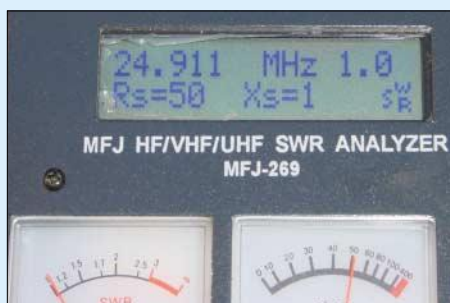
Bild 8: Hier handelt es sich um die reale Messung einer J-Antenne für das 12-m-Band und nicht um die Messung einer Dummy-Load.
