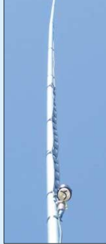
Bild 6: Diese J-Antenne für das 6-m-Band, an einer Glasfibrer-Angelrute befestigt, tat bei DK7ZB in der E S -Saison 2005 als Empfangsantenne ihren Dienst. Fotos: DK7ZB
