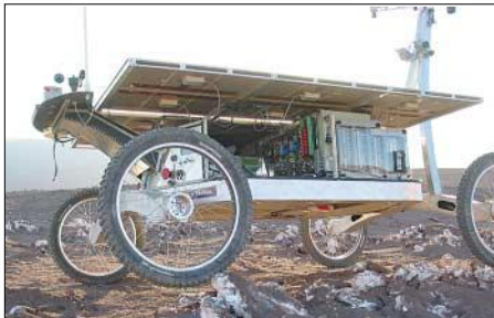
Bild 4: Unter dem Dach aus Solarzellen wurden u.a. der Steuerrechner und die Akkumulatoren untergebracht.
