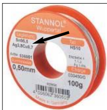
Bild 3: Vor dem Löten sollte man sich anhand der aufgedruckten Legierung über die erforderliche Temperatur informieren.
