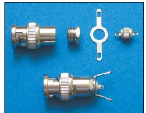
Bild 5: Umbau von BNC-Steckern zu Messadaptern Foto: HB9OJ
